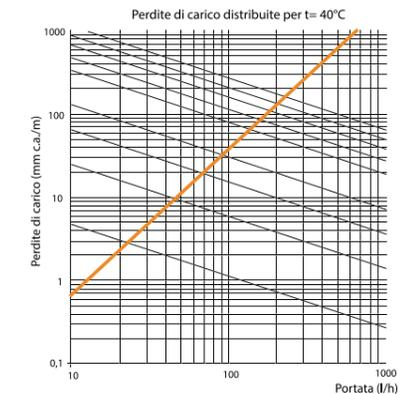
Tubo Kaloa K-XA12 in Pe-Xa 12x1.5 mm composto da 5 strati per sistemi di riscaldamento e raffreddamento a pavimento. Facile da installare, impermeabile all'ossigeno e altamente resistente all'usura (evitare l'esposizione prolungata ai raggi UV). La bassa rugosità superficiale dello strato interno impedisce il deposito di sedimenti ed incrostazioni. Lo strato
