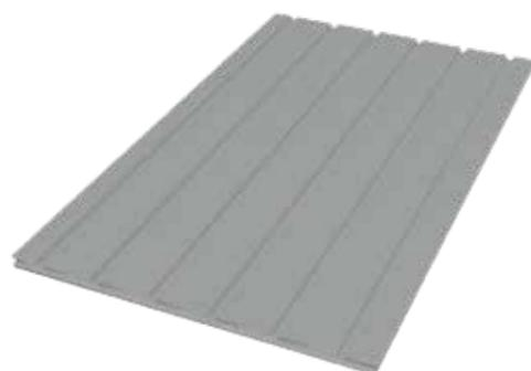
Lastra Kaloa K-GF D, dritta, spessore 15/18 mm con passo di posa tubazione 100 mm, e spessore 25 mm con passo di posa 150 mm
